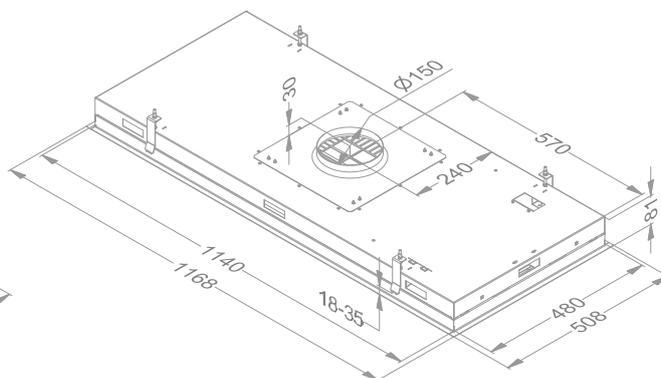
(1) La hotte doit être connectée avec le moteur dissocié extérieur 445.999 ou un moteur extérieur pour toiture plate (voir accessoires). Le débit d'air et le niveau sonore dépendent de l'installation.
