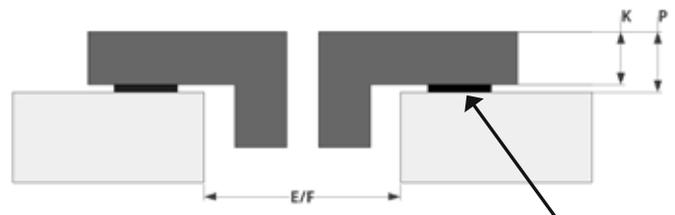
Bande imperméable de 2 mm
